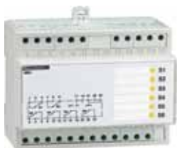
M6C programozható érintkezők: a megszakítón kívül lévő relé 6 különálló váltóérintkezővel, háromvezetékes csatlakozással, amelyeket a megszakító működtet.
